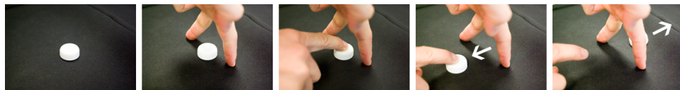
Abbildung 9: Erste Beschreibung der Slingshot-Multitouch-Idee durch eine Fotoserie. Deutlich sind die einzelnen Schritte erkennbar – Objekt umfassen, Objekt packen, Objekt nach hinten ziehen und Objekt loslassen
